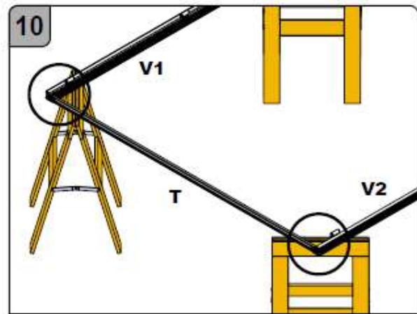
Positionieren sie die Schwelle zwischen den Ständern der Rahmenprofile
