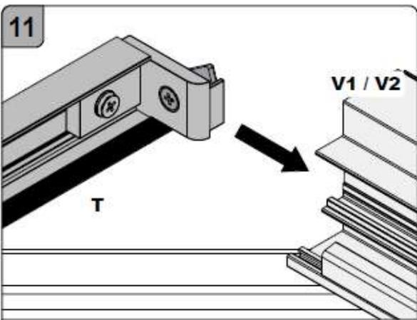
Schlitzschwelle zwischen Rahmenprofile
