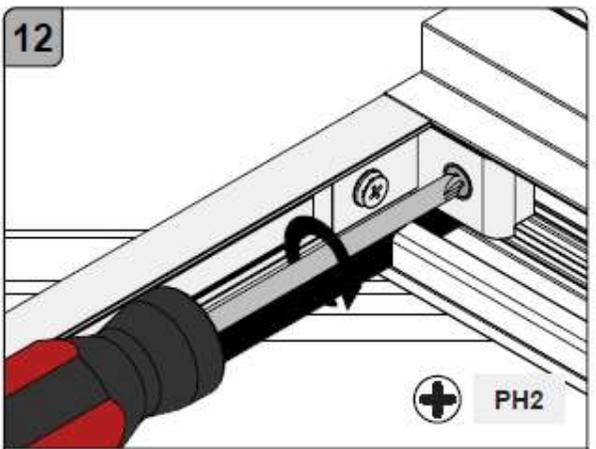
Sichern sie die Schwelle, indem sie die Klemmplatenschrauben festziehen, bis ein Widerstand spürbar ist
