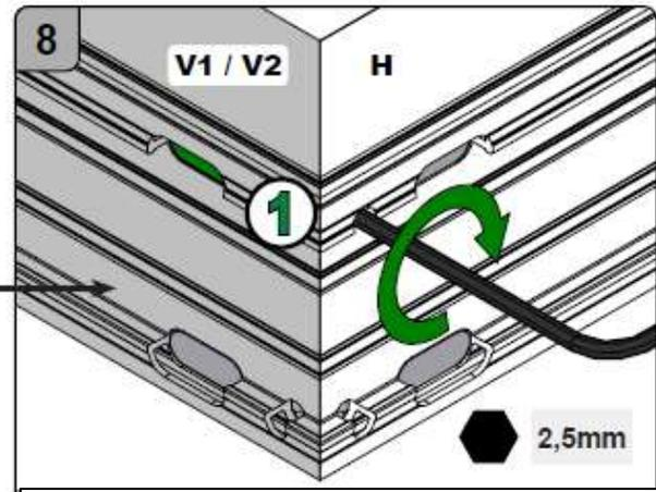
Sichern sie die erste Klemme mit einem Innensechskantschlüssel
